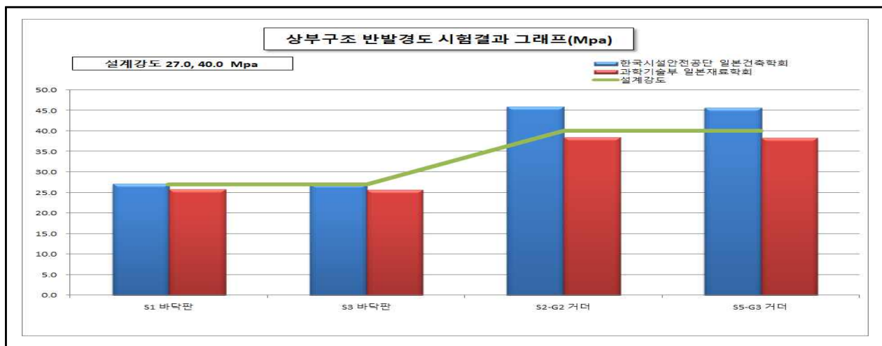
【그림 14.4.3】 상주방향 상부구조 반발경도시험 측정결과
